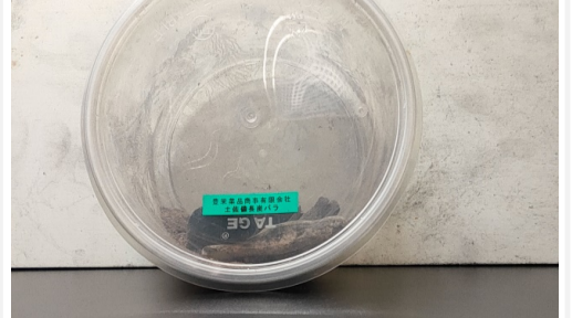
④写真-消し炭と灰(燃え残り、灰の確認用)
